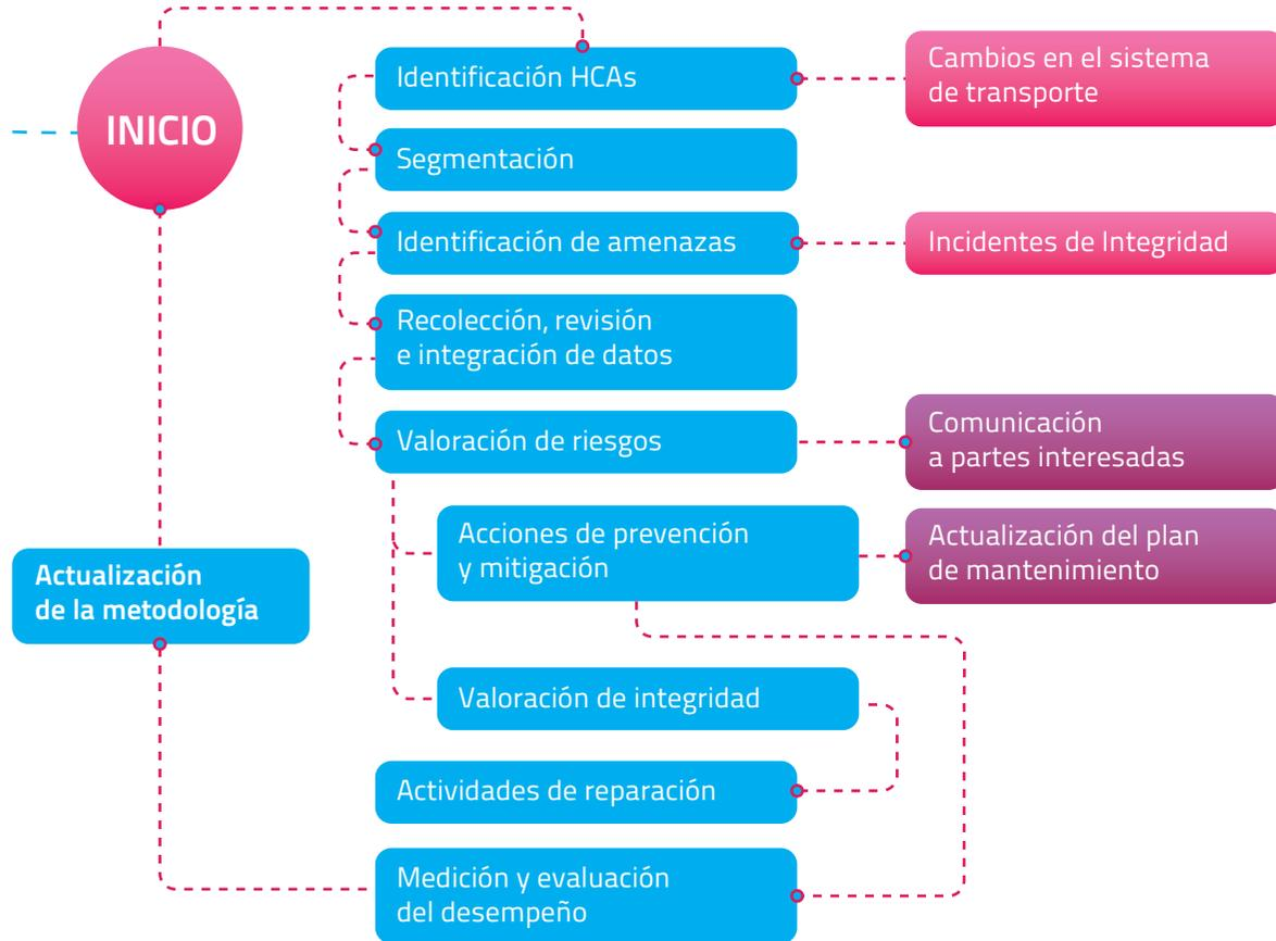
Gracias a este sistema de integridad, los riesgos de infraestructura se mantienen controlados y se aplica un plan de mantenimiento diferencial y enfocado según la valoración, con el objetivo principal de disminuir la probabilidad de ocurrencia. Adicionalmente, nuestro sistema está provisto con válvulas que se cierran automáticamente al detectar cualquier fuga o escape.
